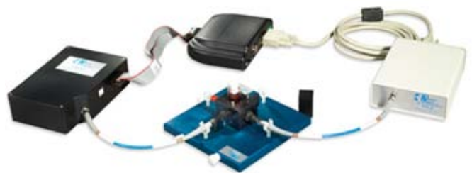
HR4000 分光器と HR4-BREAKOUT の接続例
